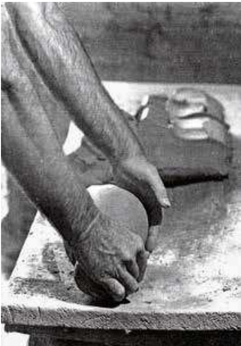
Fig. 18. Se conforman las bolas (todas de idéntico tamaño).
