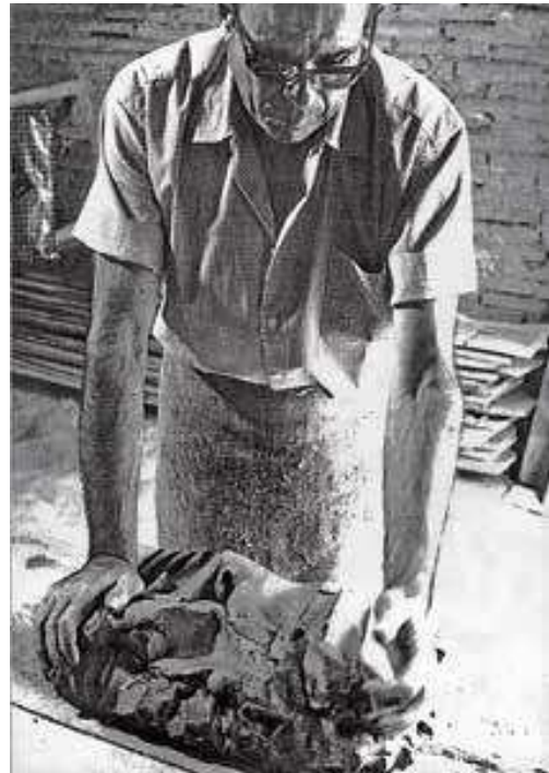
Fig. 13. Se hermana con golpes fuertes y secos.
