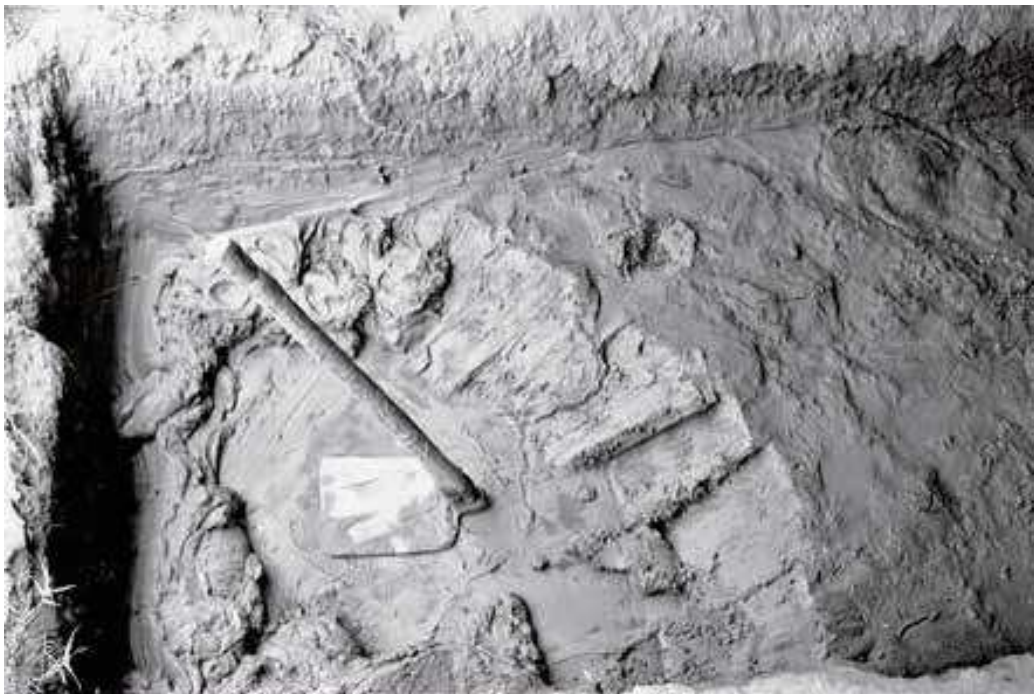
Fig. 10. Tierra ya colada y tratada. Ladrillería Llena (Corçà). Fotografía: Albert Llenas. Procedencia: Terracotta Museu Servei d'imatges .
