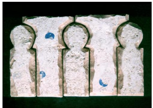
Piezas de mosaico cortadas de un azulejo esmaltado cocido visto por detrás. Los bordes se han biselado para que se pueda poner mortero entre las juntas.
