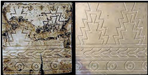
Fig. 11. Moldes de madera y acero, respectivamente, para prensar azulejos de arista. La Ceramo, 1890 – 1910.
