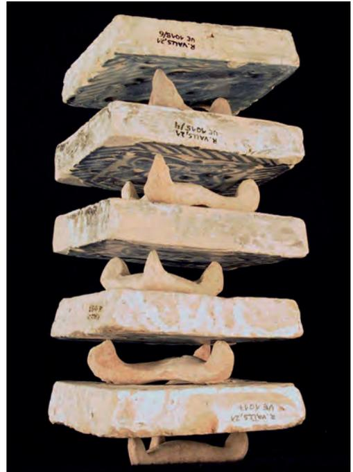
Fig. 19. Forma de colocar los azulejos en el horno, usando trébedes como separadores.
