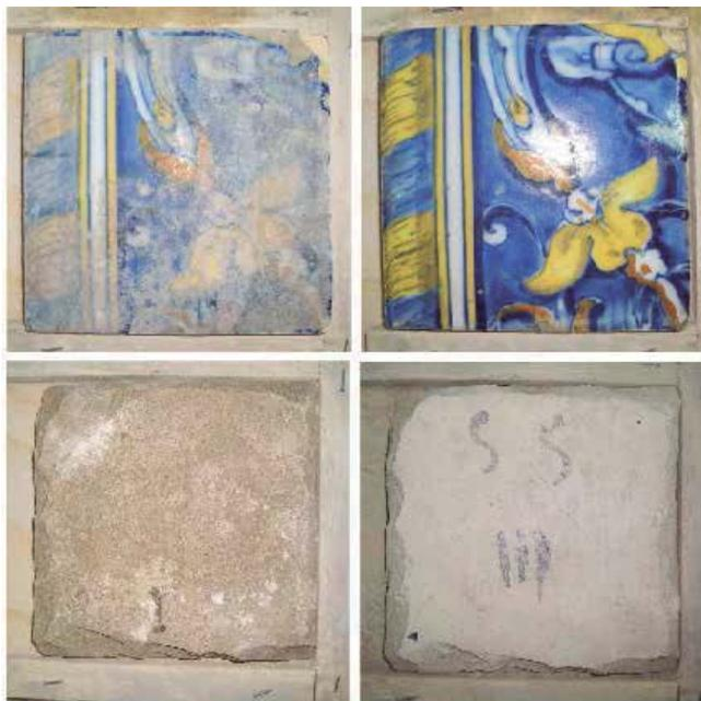
Fig. 9. Azulejo antes de la eliminación de las sales carbonatadas sobre el vidriado y después de eliminadas. Y antes de la eliminación del mortero de agarre y después, ya visible su sigla y numeración.
