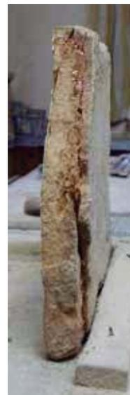
Fig. 8. Exfoliación del biscocho y desprendimiento de los vidriados. Proceso de consolidación mediante inyección de Paraloid B-72.
