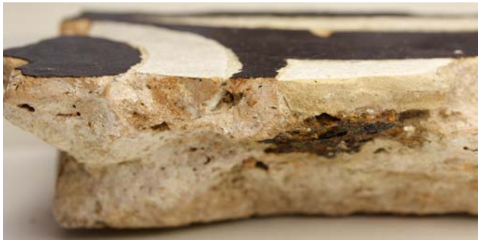
Fig. 6. Restos de óxido dejado por la cabeza de un clavo de fijación por debajo de una pieza incrustada
